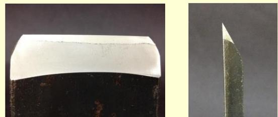
図5 開発した研ぎ機を用いて研磨したかんな刃
