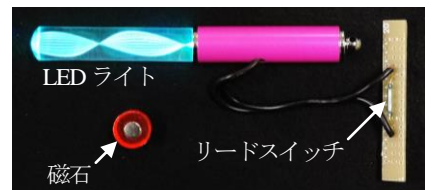
図2 LEDライト・リードスイッチと磁石
