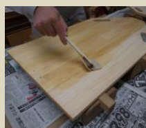
図6 防腐剤の塗布
